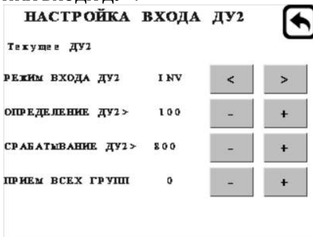
Рис. 19. Внешний вид меню настроек по входу подключения УДП
