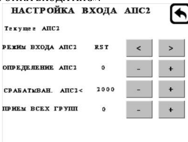
Рис. 20. Внешний вид меню настроек по входу подключения АПС
